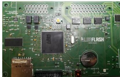
Zunächst wurden die notwendigen Funktionen der ECU ermittelt und anschließend ein Schaltplan erstellt. Die Platine der ECU hat die Firma Eurocircuits professionell für uns gefertigt. Die Platine wird mit dem Microcontroller, Kondensatoren, Widerständen und weiteren Bauteilen bestückt und ist inzwischen fast fertig.
